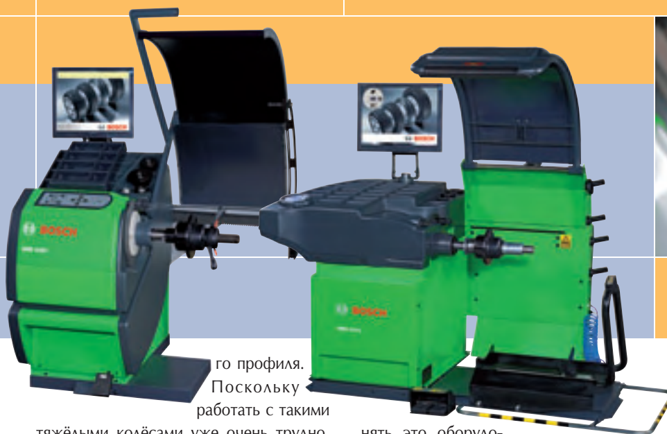
Станки WBE 4420 (слева) и WBE 4515, лазерный указатель точки установки грузика
