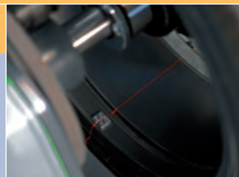
Станки WBE 4420 (слева) и WBE 4515, лазерный указатель точки установки грузика
