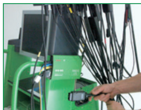
Консольные мотортестеры адаптированы для совместной работы со сканером.
