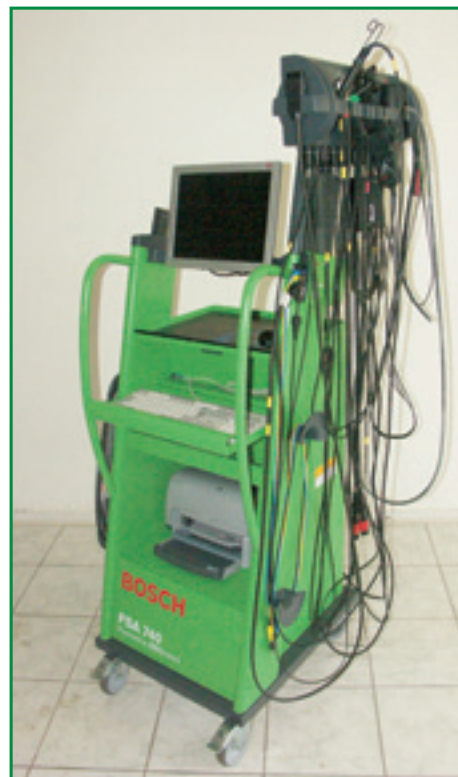
FSA 740 — консольный мотортестер нового поколения, унаследовавший «породу» от знаменитых приборов FSA 5-й серии.
