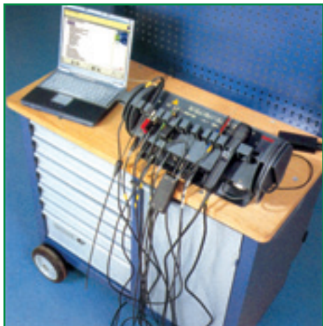
Модульная структура приборов FSA 7-й серии позволяет комплектовать систему моторной диагностики поэтапно. Измерительный модуль FSA 720 в комбинации с компьютером — полноценный мотортестер.
