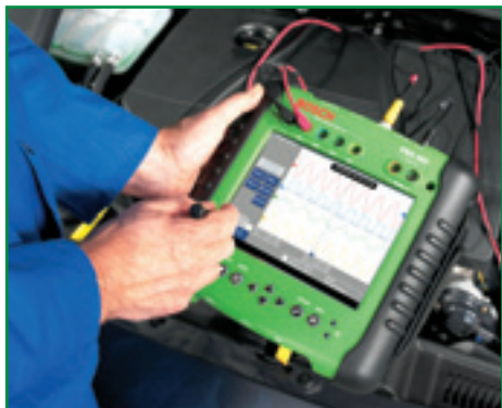
Экономичная альтернатива «консолюнику» — портативный мотортестер, например, такой как FSA 450.
