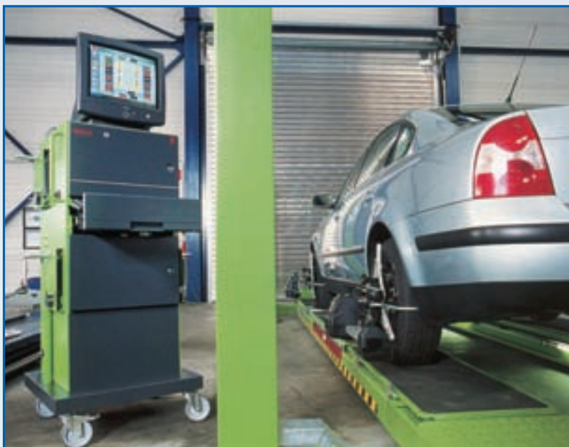
Стенд измерения углов установки колес — один из видов оборудования, подлежащего ежегодной метрологической аттестации. Успешно ее пройти без периодического обслуживания и калибровки невозможно.
