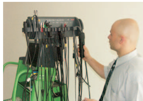
Измерительный модуль FSA 720 представляет собой совокупность полного комплекта датчиков и аналогово-цифрового преобразователя. Это позволяет использовать его в качестве эффективного инструмента моторной диагностики и базового устройства интегрированной диагностической системы.
