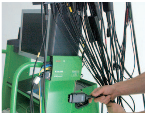
Для диагностики электронных блоков управления в составе интегрированной системы используется универсальный сканер модели KTS 520.
